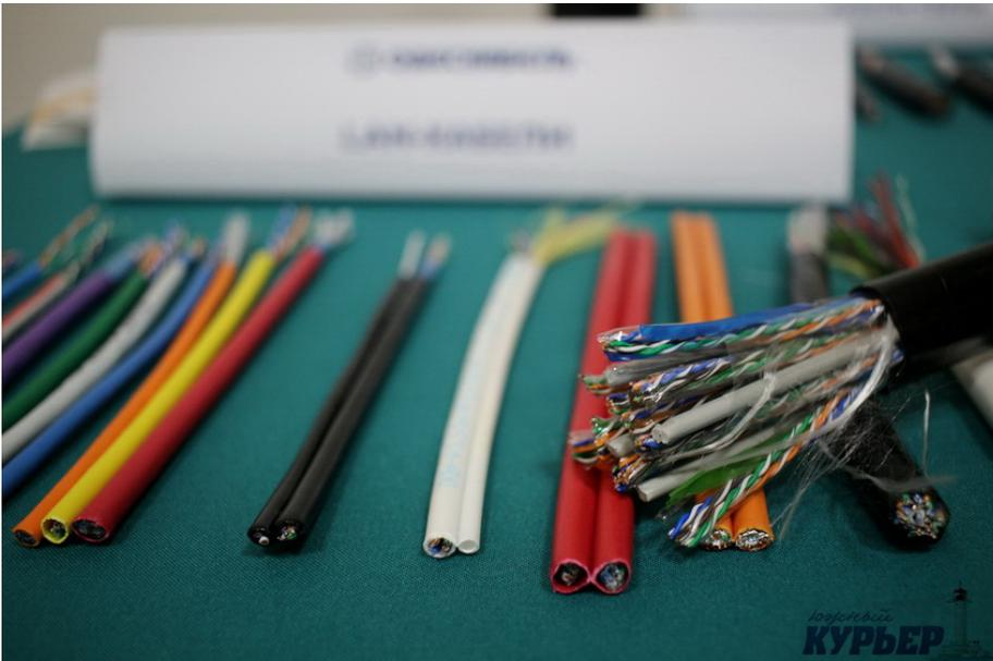
Сейчас на заводе выпускают и более совершенные кабели этой технологии, категорий "6", и выше, до "6Е" включительно. По ним можно передавать данные на различных скоростях - от 2,5 до 10 гигабит в секунду. Девиз нового производственного комплекса
