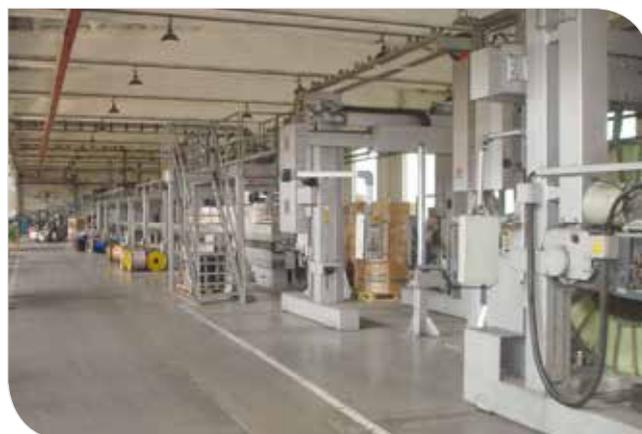
Линия по производству силового кабеля
