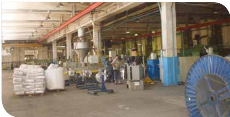
В мешках – сырье для изготовления сшиваемого полиэтилена
